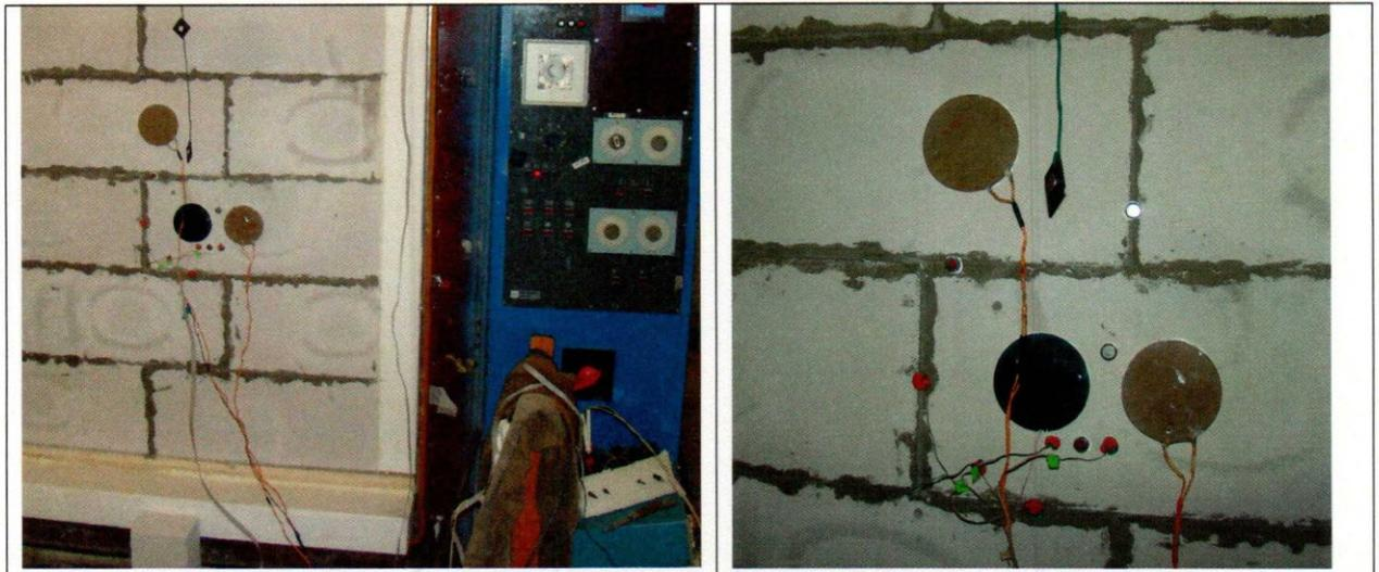
Рис. 3. Проведение экспериментальных определений теплопроводности в кладке блоков из ячеистого бетона автоклавного твердения на клею
